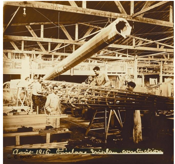
Usine Voisin – août 1916 – construction du fuselage d'un triplan
