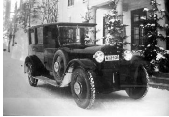
Cette voiture Voisin est arrivée en Suède sous forme de châssis puis a été carrossée en landaulet par Gustaf Nordbergs Vagnfabrik.
