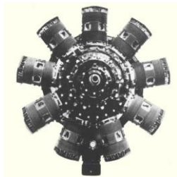
Bristol Perseus , neuf cylindres en étoile, réducteur, compresseur un étage (1932)
