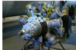
Bristol Hercules , quatorze cylindres en double étoile. Une chemise avec sa lumière est visible sur le cylindre en haut à gauche
