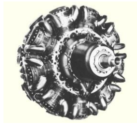
Bristol Centaurus , 18 cylindres en double étoile, puissance de 2.500 cv
